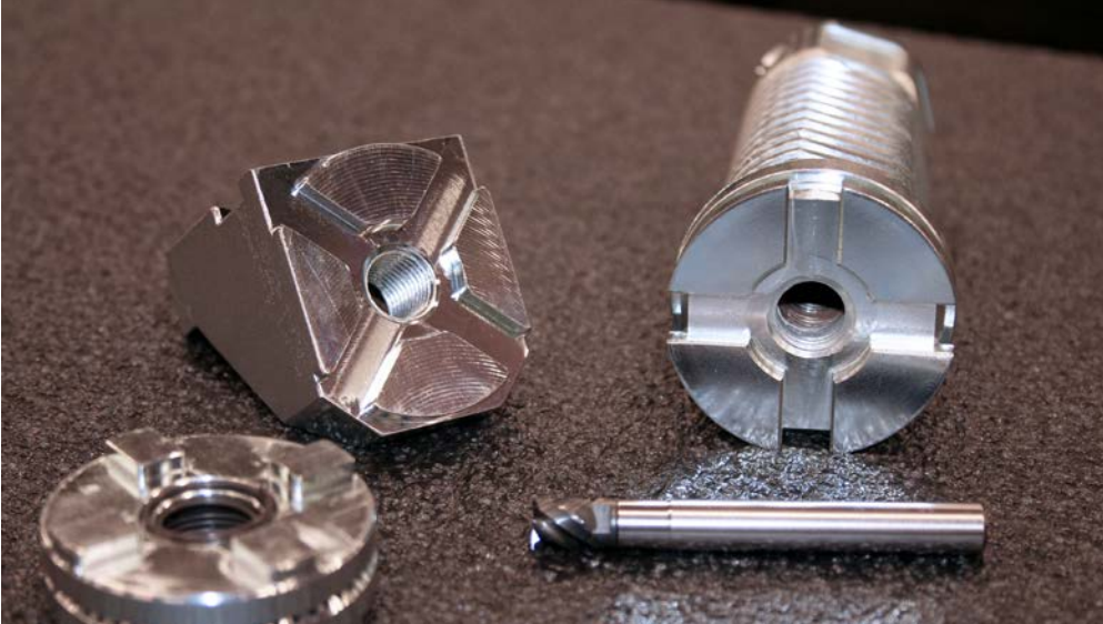
iMX:s pinnfräs med utbytbara fräshuvuden och de färdigbearbetade komponenterna
