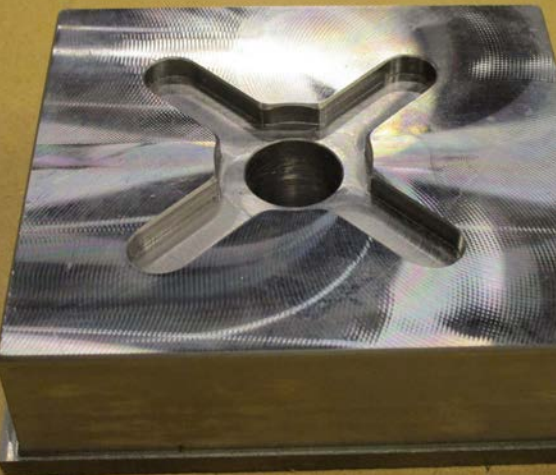
Semibearbetad modulär honkomponent för fasthållning
