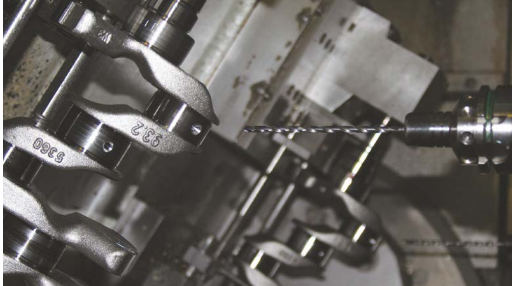
MPS1 – djuphålsborrning av vevtappar in till huvudlagret utförd i en Grob BZ 530-maskin med dubbla spindlar
