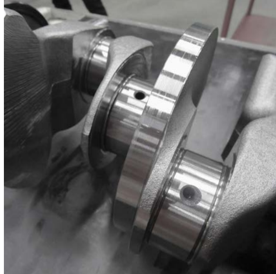
Diagonalt hål Ø5,00 mm, 100 mm djupt.
