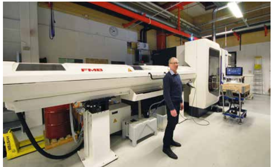
Det senaste levererade och installerade stångmagasinet från FMB Turbo 5-65 V kopplad till en DMG Mori NTX1000 Big Bore, utrustad med individuellt justerbara styrkanaler.
