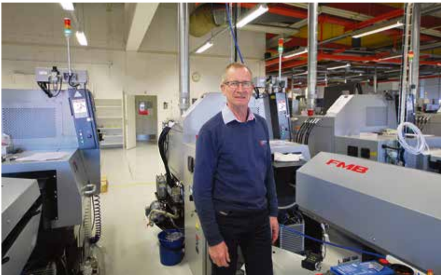
Här står Lennart vid två stångmagasin FMB Turbo 2-20 kopplade till två Tsugami BO 125E-III.
