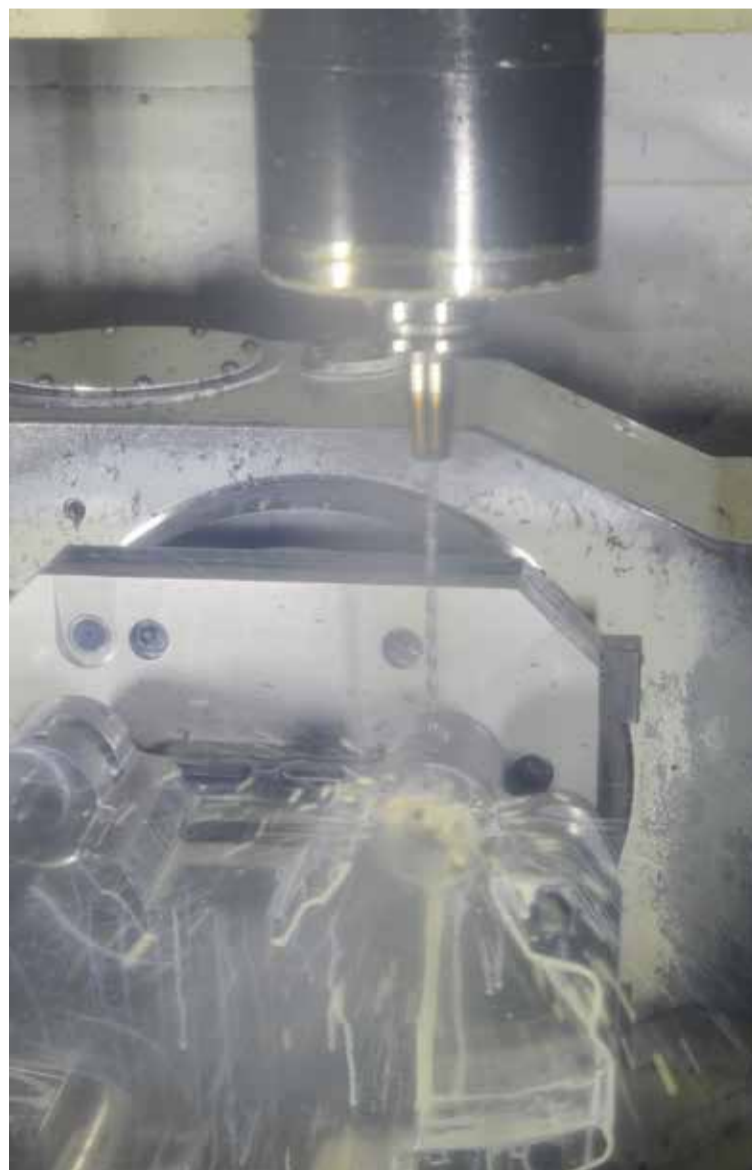
På Atling använder man framgångsrikt sedan många år Mitsubishi MPS1 Superlong för max borrhjup 12 – 40xD. Här ser vi hur kylmedlet flödar ut ur kylkanalerna på ett effektivt sätt. Kombinationen av högre flöde och hastighet är väsentlig för att effektivt avlägsna spånorna. Effektiv spånavgång möjliggör kontinuerligt höga prestanda inom ett brett spektrum av arbetsmaterial och applikationer.
