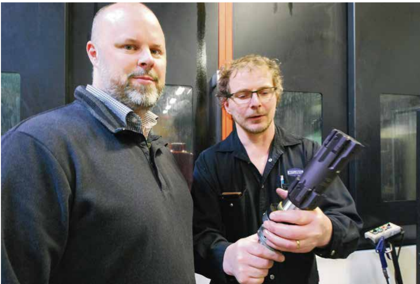
Anders Kock och Kenneth Nyholm visar upp en stegbrotsch HPR300 från den tyska verktygstillverkaren Mapal. Ett vägvinnande verktygsval som gjort att maskintiden kunnat trimmas ner rejält.
