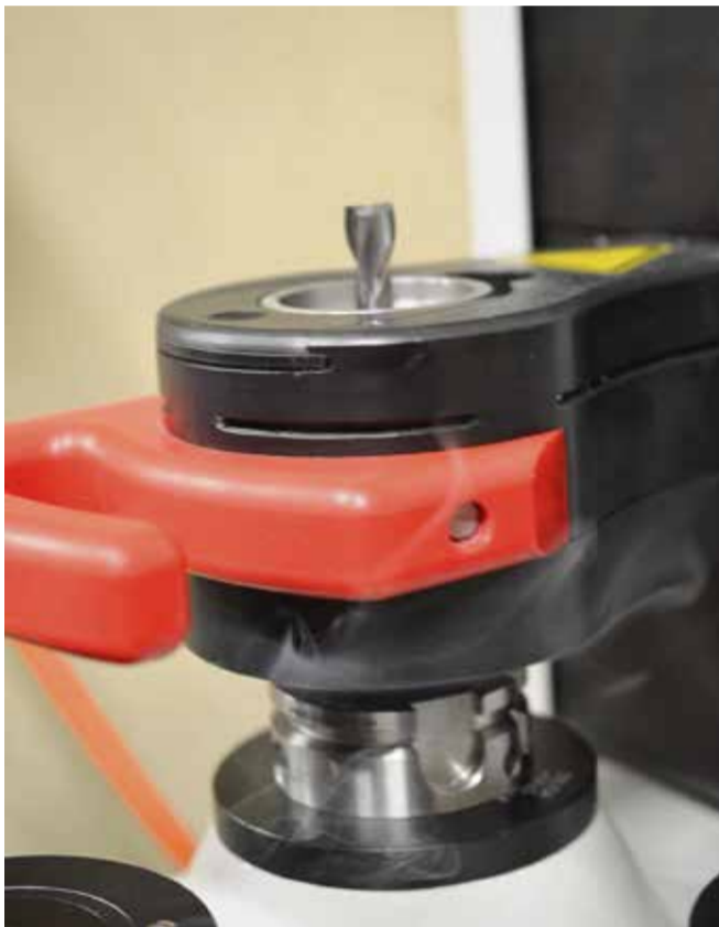
Krympförbandet skapas genom att en verktygshållare värms upp i mellan 2,5 till 5 sekunder och när verktyget sedan sätts i, svalnar hållaren och verktyget sitter fast.
