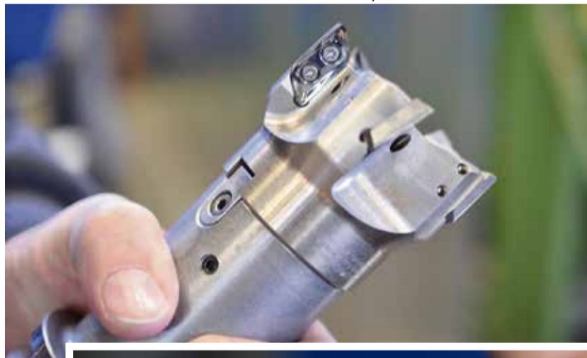
Planfräs Mitsubishi AXD 4000 diameter 63 mm med slipade hårdmetallskär.
