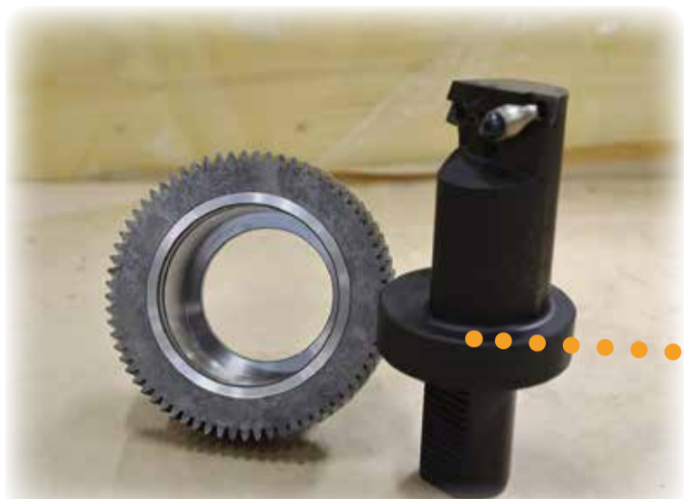
För att optimera processen i det trånga utrymmet togs en specialhållare fram av Mitsubishi EPE. Den stabila hållaren klarar av att bearbeta en invändig diameter och ett plan med två olika CBN-skär i samma operation.
