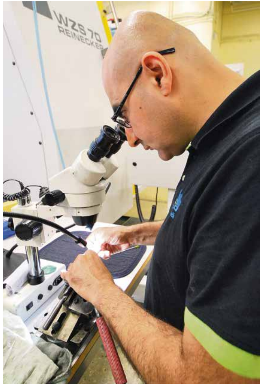
Zheer Nadham jobbar med egg preparering av ett omslipat verktyg med en diamantfil. Här pratar vi om fingertoppskänsla med handpåläggning ner till 3 mm och det handlar om att hantera filverktyget om hundradelar, ett riktigt omväxlande operatörsjobb och hantverk.
