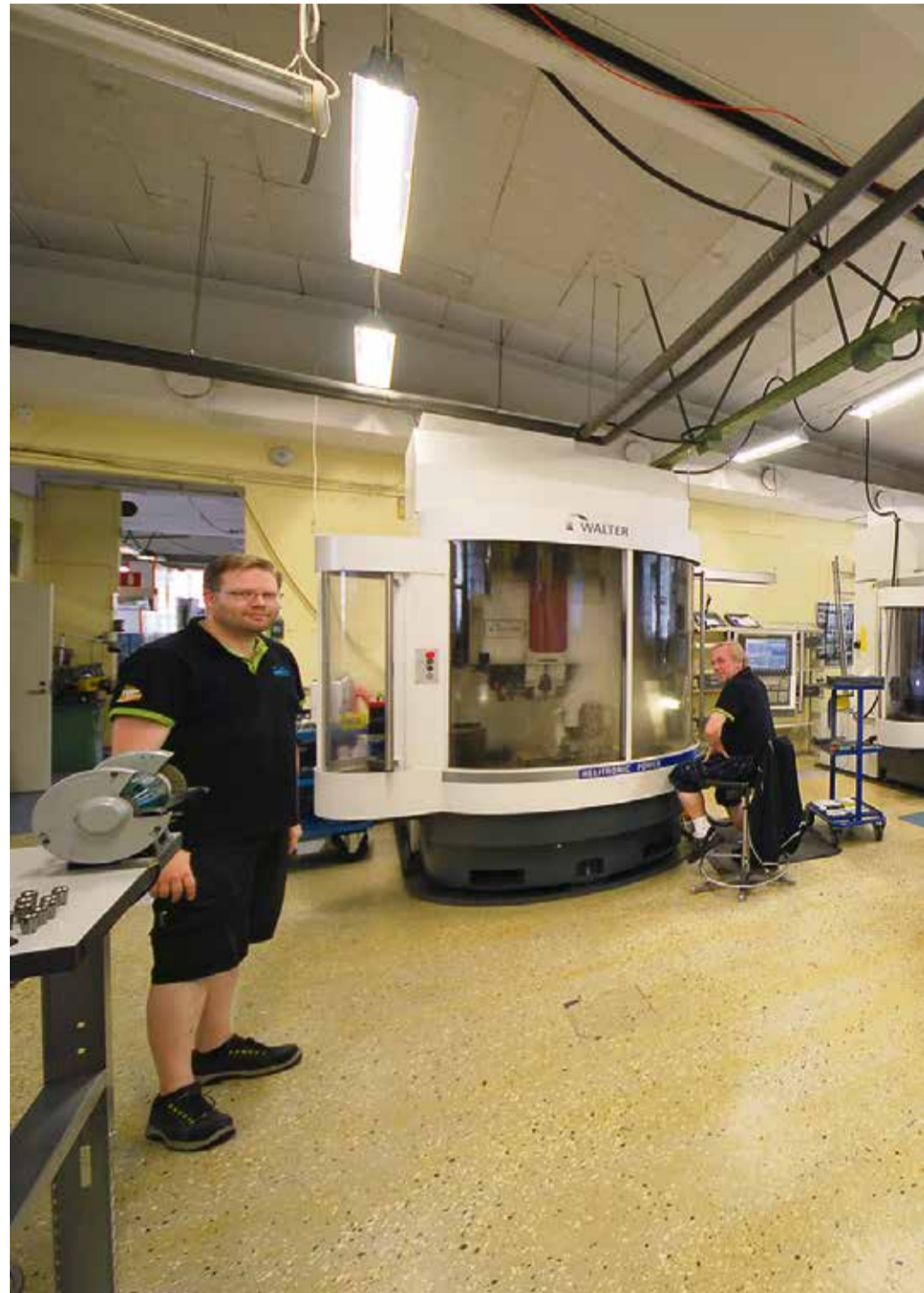
Här finns nu fyra CNC slipmaskiner på plats i verkstaden, två Reinecker WZS70 och två Walter Power, varav tre är utrustade för obemannad körning. Avancerade mätutrustningar från Haimer Microset, Mapal och Kelch, samt ett antal manuella maskiner ger Colly Slipservice mycket bra möjligheter till att vara ett verktygssliperi av högsta Europaklass.
