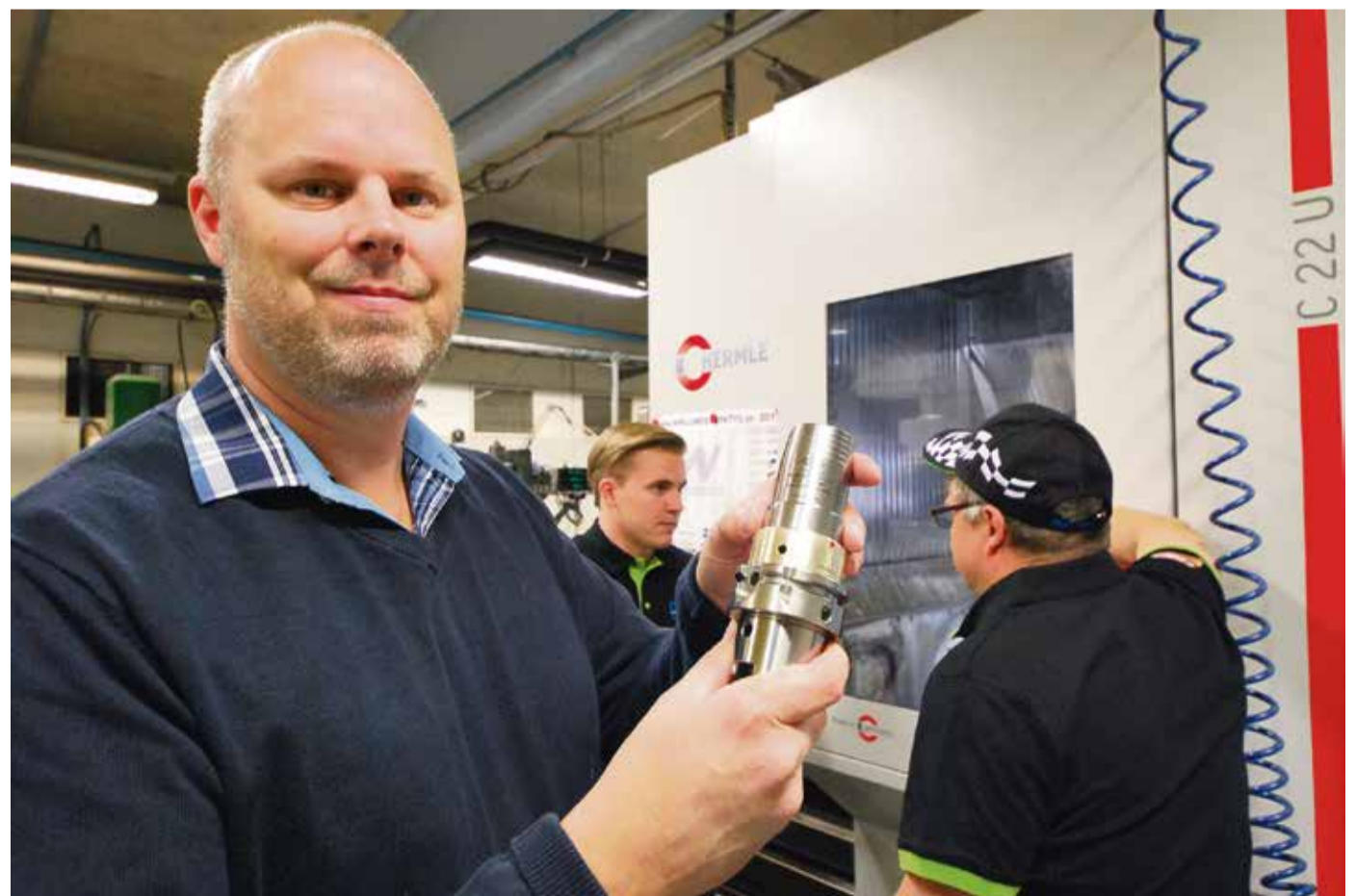
En annan verktygshållare som Anders Kock visade upp var en hydraulchuck HTC MAPAL med en kastjustering, framförallt väldigt bra om kunden har en brotschapplikation och kan ställa bort kastet i maskinspindeln som gör att hen får perfekta brotschhåll.
