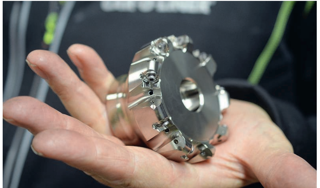
En "fräskrabba" från Mitsubishi 9-skärig hörnfräs WWX 400. Konvexa skärkanter på skären gör att spånorna inte kläms mellan skäret och den frästa ytan. Tandningen kan fås med 3 olika täthet på många av diametrarna.
