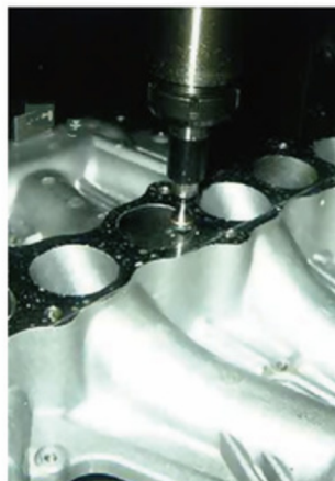
Gradning av insug.
