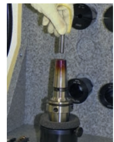
Die abgebrochene Schneide kann bequem herausgezogen werden
