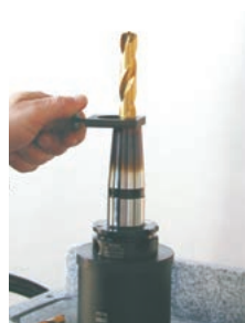
Schneidwerkzeug bis zum Anschlag einsetzen
