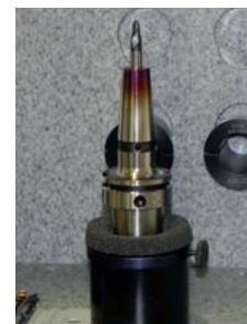
Schrumpffutter erwärmen. Sobald das Schrumpffutter die Ausschrumpftemperatur erreicht hat, fällt es auf die Dämpfungsscheibe
