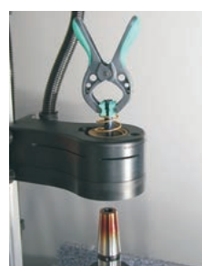
Zange wird mit dem Schneidwerkzeug nach oben gedrückt. Der Induktor kann hochgefahren werden
