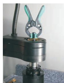
Druckfeder ist gespannt, das Schneidwerkzeug wird von der Zange gehalten. Schrumpffutter erwärmen
