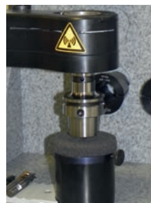
Schrumpffutter erwärmen. Sobald das Schrumpffutter die Ausschrumpftemperatur erreicht hat, fällt es auf die Dämpfungsscheibe
