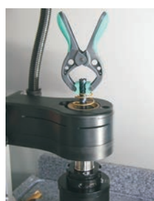
Druckfeder ist entspannt, sobald das Schrumpffutter die richtige „Loslass-Temperatur“ hat
