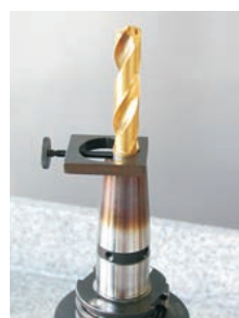
Schrumpffutter abkühlen lassen
