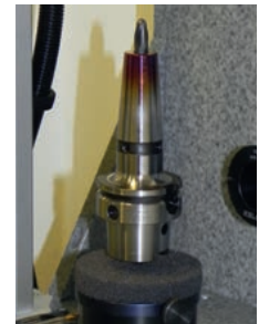
Schrumpffutter auf den Pin setzen
