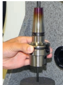
Länge bis zum Anschlag der Werkzeugschneide bestimmen
