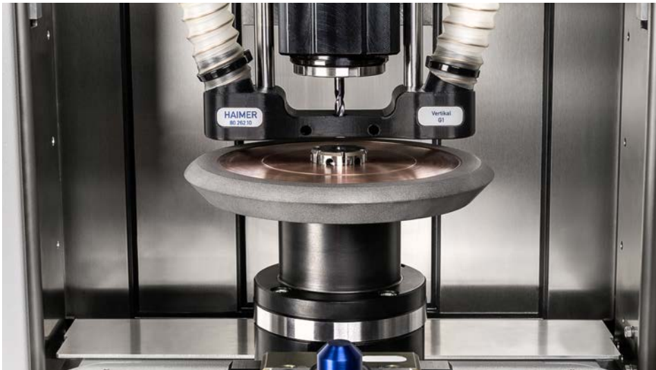
Auswuchten einer Schleifscheibe durch axiales Bohren
